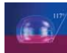
Figura B. Picătura de apă pe vinilpolisiloxan neîntărit. La început vinilpolisiloxanii se comportă ca materiale hidrofobe. 1
