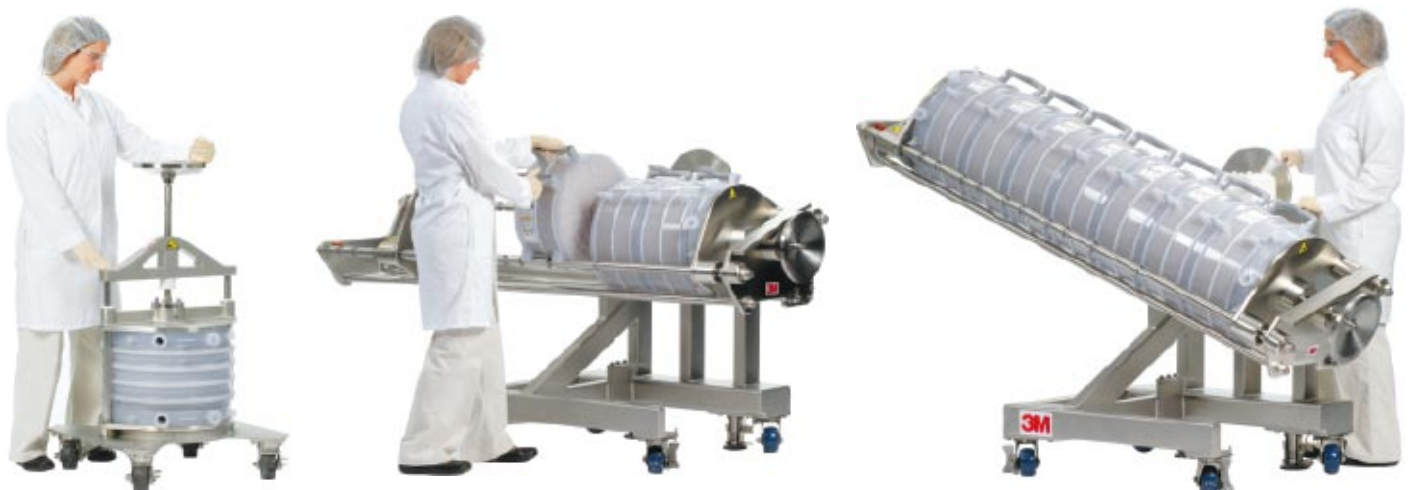
Jedes Zeta Plus Einwegtiefenfiltersystem besteht aus dem Filterhalter, einem Set von Einweganschlussstücken und einer variablen Anzahl von Filtercapsulen. Der Filterhalter kann von der horizontalen in die vertikale Position geschwenkt werden, um das Laden und Entladen in Hüfthöhe zu erlauben sowie den Platzbedarf und die Produktverluste zu minimieren.
