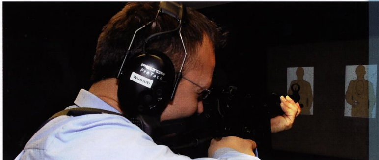
Der neue pegelgedämmte Gehörschutz für die Schießanlagen in Enkenbach, Wittlich, Koblenz und Mainz verfügt über Mikrophon, Prozessor und Lautsprecher: Sprache wird transportiert, Schießgeräusche werden ausgefiltert.
